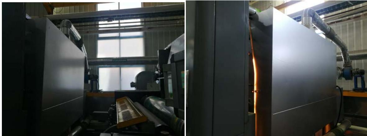
图 4-5 印刷机集气罩
